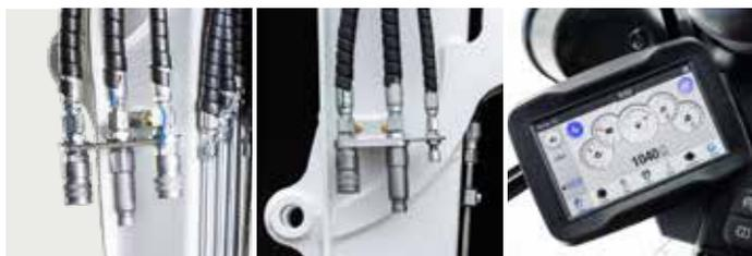
Circuit hydraulique auxiliaire (AUX1) sur le balancier
