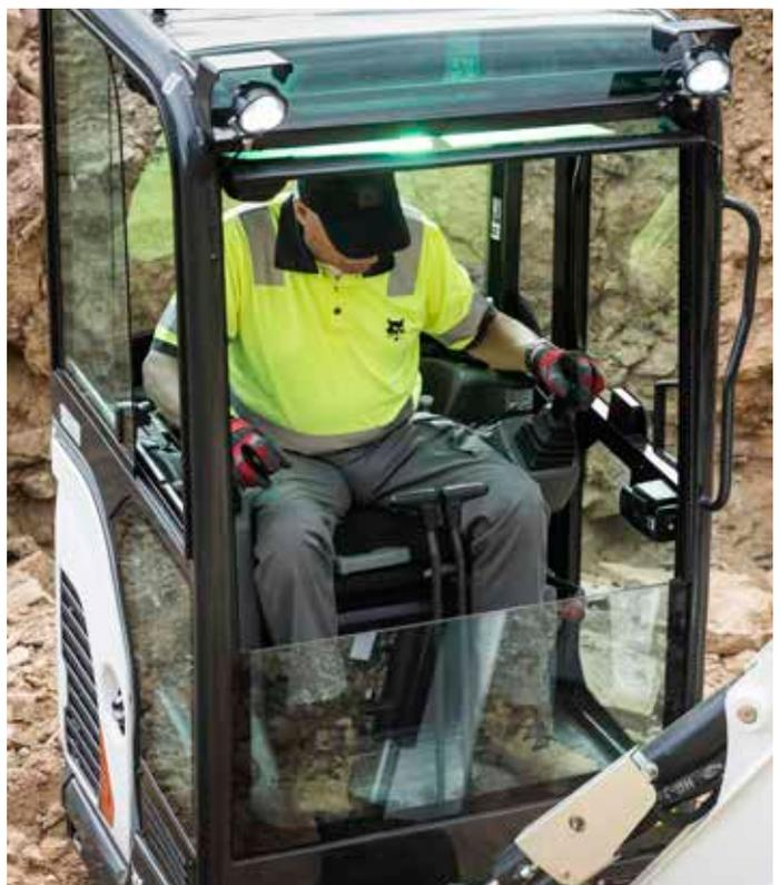
Cabine TOPS / ROPS avec chauffage
