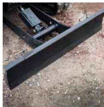
Lame de remblayage avec extensions hydrauliques
