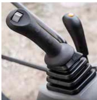
Commande par manipulateurs hydrauliques
