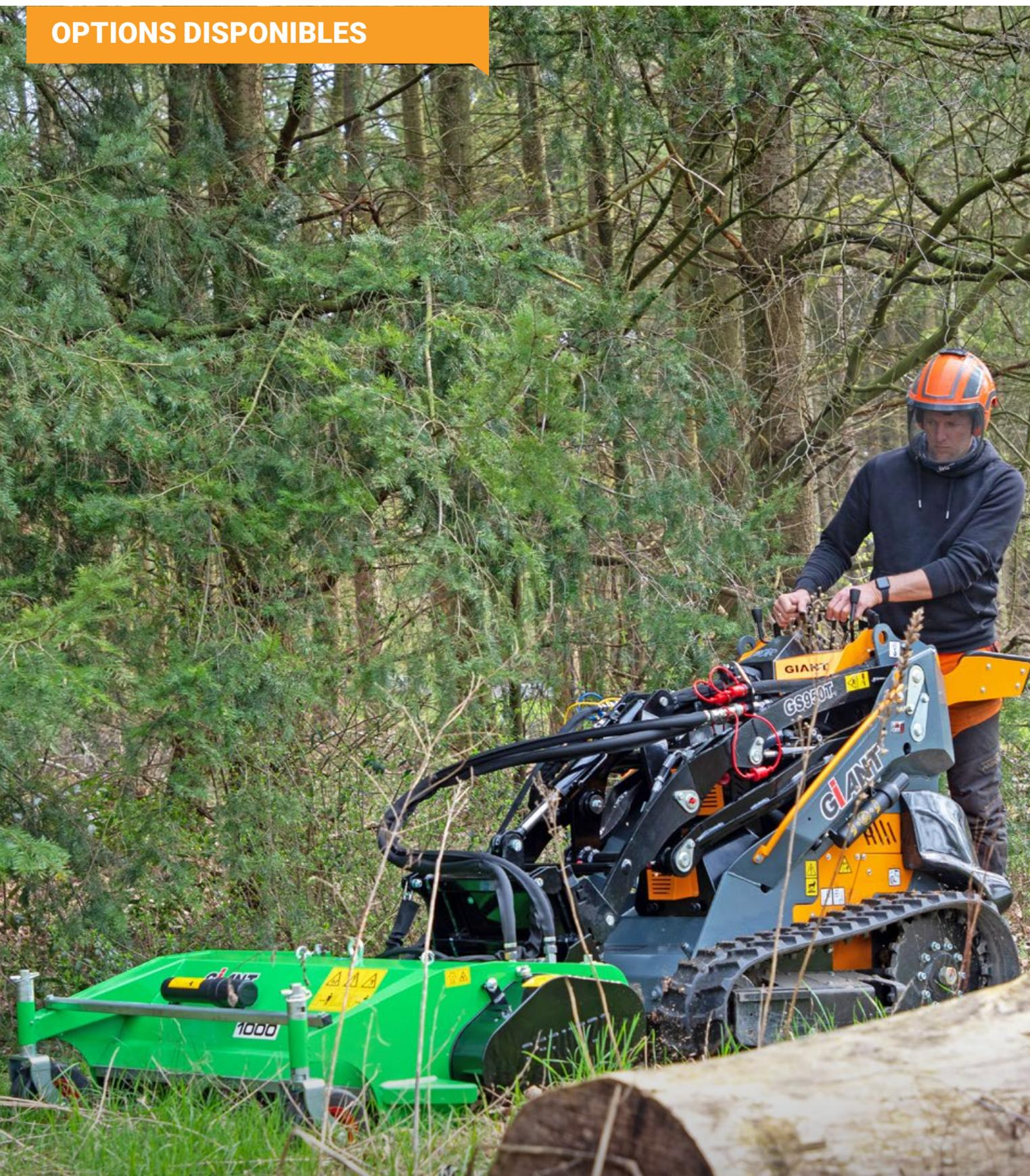
Avec l'option latérale de blocage hydraulique, le flux hydraulique est maintenu, ce qui permet à l'accessoire hydraulique, tel qu'une tondeuse, de continuer à fonctionner sans que l'opérateur n'ait besoin de maintenir constamment le levier hydraulique.
