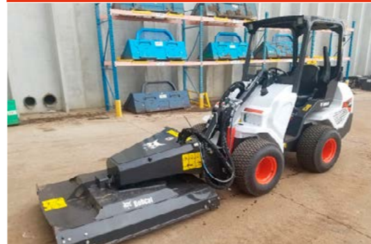
Débroussailleuse à lames Brushcat™ : livrée de série avec une lame décalée de 7 cm et des roues avant. Hauteur de coupe de 7,6 cm.
