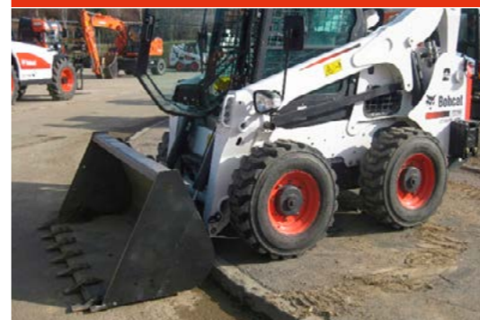
Godets de chargement et transport : dotés de trous prépercés pour accueillir le bord d'attaque ou les dents à boulon.
