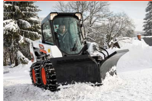
Lame chasse-neige en V : la chargeuse doit être équipée d'un kit de commande des accessoires. Sur une chargeuse équipée du kit de commande des accessoires à 14 broches, un kit de faisceau en T à 14 broches est nécessaire.
