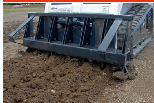
Scarificateur : comprend 2 guides de profondeur et 5 dents.
