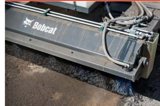
Balayeuse à godet collecteur : La machine doit être équipée d'un circuit hydraulique auxiliaire à l'avant.
