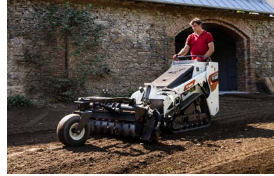
Râteau motorisé : la chargeuse doit être équipée d'un kit de commande des accessoires.
