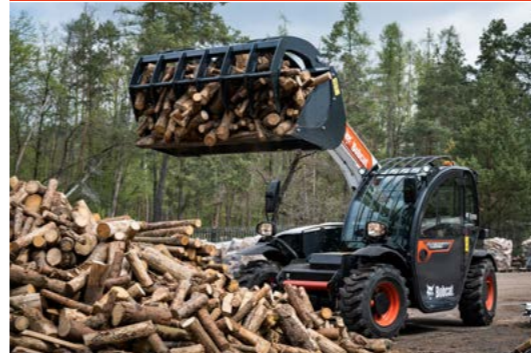
Grappin à godet : La machine doit être équipée d'un circuit hydraulique auxiliaire à l'avant.
