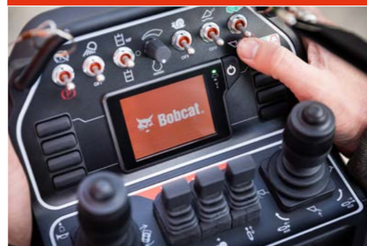
Commande à distance : Commandes SJC indispensables pour l'application de commande à distance
