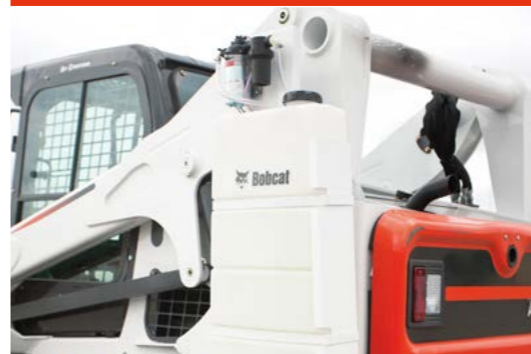
Kit d'arrosage : nécessite un kit de fixation, un kit d'arrosage et un kit de buses.
