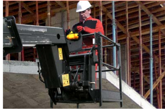
Nacelle : la machine DOIT être commandée avec l'option « Nacelle préinstallée » (option ne pouvant pas être installée ultérieurement). La télécommande radio est obligatoire pour utiliser la nacelle.
