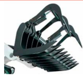
Grappin à déraciner : à fixer sur le godet. Il est recommandé d'utiliser un clapet de sécurité secondaire 7502313. La machine doit être équipée d'un circuit hydraulique auxiliaire à l'avant.
