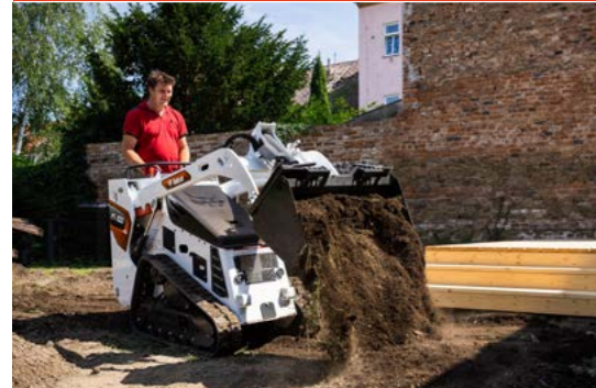
Godets standard (GP) : dotés de trous prépercés pour accueillir le bord d'attaque ou les dents à boulon.
