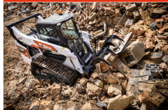
Grappin industriel : comprend un bord d'attaque boulonné. Il est recommandé d'utiliser un clapet de sécurité secondaire.
