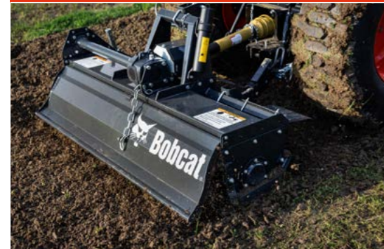
Cultivateur rotatif : prise de force arrière 540 tr/min.
