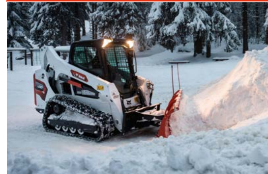
Lame chasse-neige : comprend un angle hydraulique
