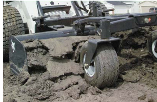
Lame niveleuse : La machine doit être équipée d'un circuit hydraulique auxiliaire à l'avant.
