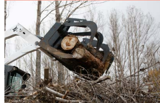
Grappin à déraciner : à fixer sur le godet. Il est recommandé d'utiliser un clapet de sécurité secondaire 7502313. La machine doit être équipée d'un circuit hydraulique auxiliaire à l'avant.
