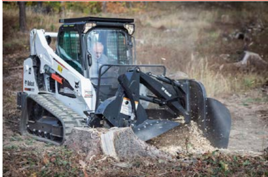
Dessoucheuse : la chargeuse doit être équipée d'un kit de commande des accessoires.
