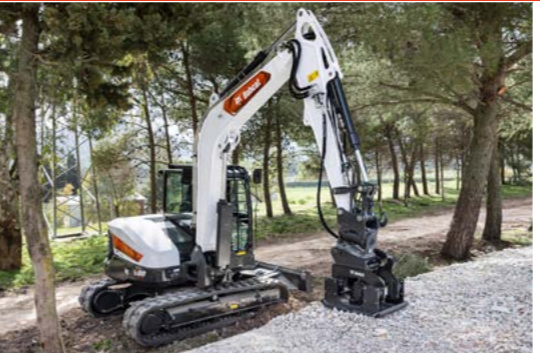
Plaque de compactage : kit de flexibles + platine de fixation + plaque de compactage
