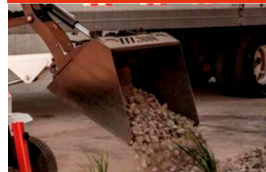
Godets utilitaires : dotés de trous prépercés pour accueillir le bord d'attaque ou les dents à boulon.
