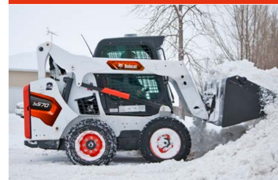
Godets à neige et matériaux légers : dotés de trous prépercés pour accueillir le bord d'attaque boulonné.
