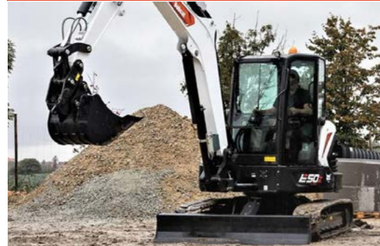
Godets : Système d'attache à fixation par broche
