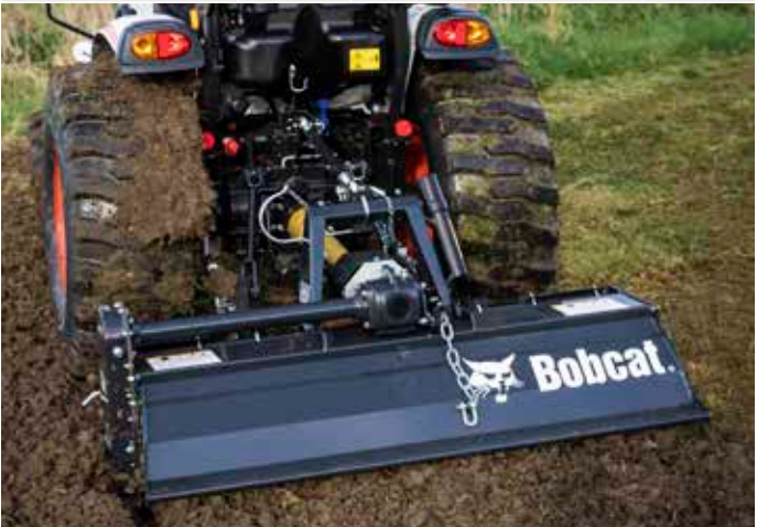
Prise de force en position arrière optimisée à 540 tr/min, qui offre un maximum d'efficacité et de connectivité : de série sur tous les modèles.
