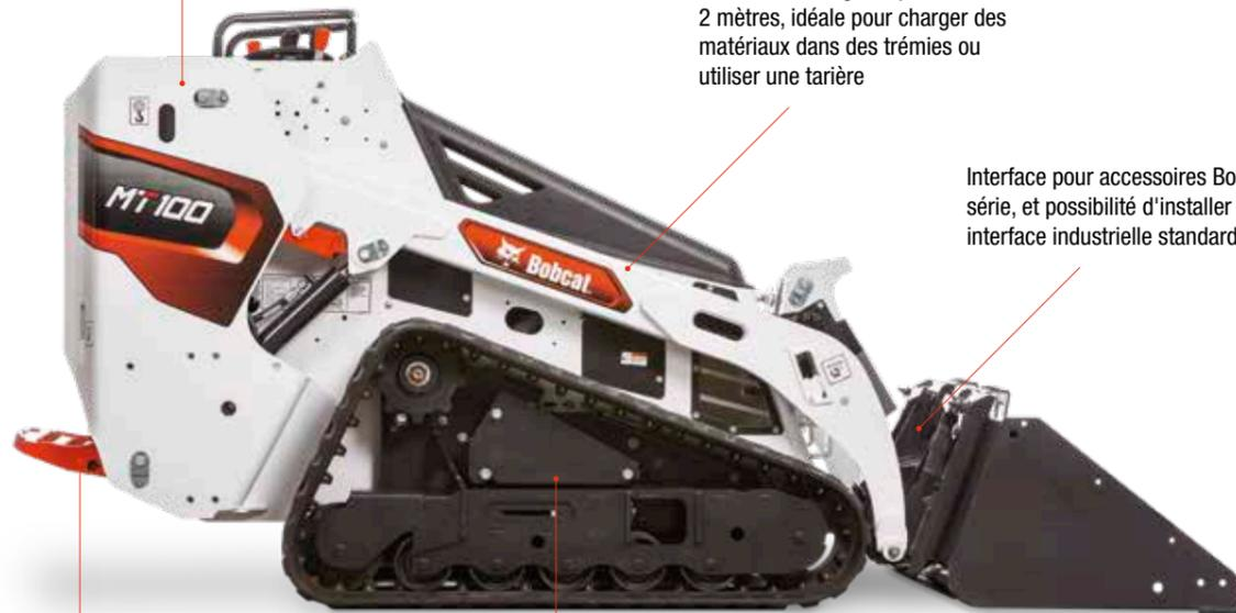
Plate-forme de l'opérateur intégrée, qui offre une position de travail confortable et sûre
