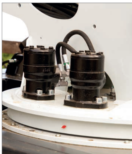
Deux moteurs de pivotement en option avec frein
