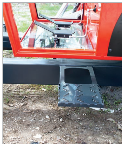
Aide à la montée pour grue mobile – des deux côtés
