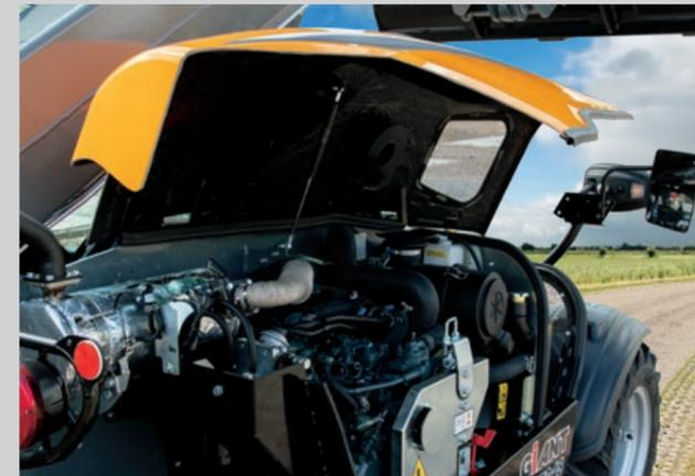
La maintenance du GT5048 est très simple grâce à des points de service faciles d'accès. Les filtres, le système hydraulique et le moteur sont libres d'accès sous le capot facile à ouvrir, la cabine inclinable ou d'autres panneaux de service. Les contrôles quotidiens et la maintenance s'effectuent ainsi rapidement et en toute sécurité.
