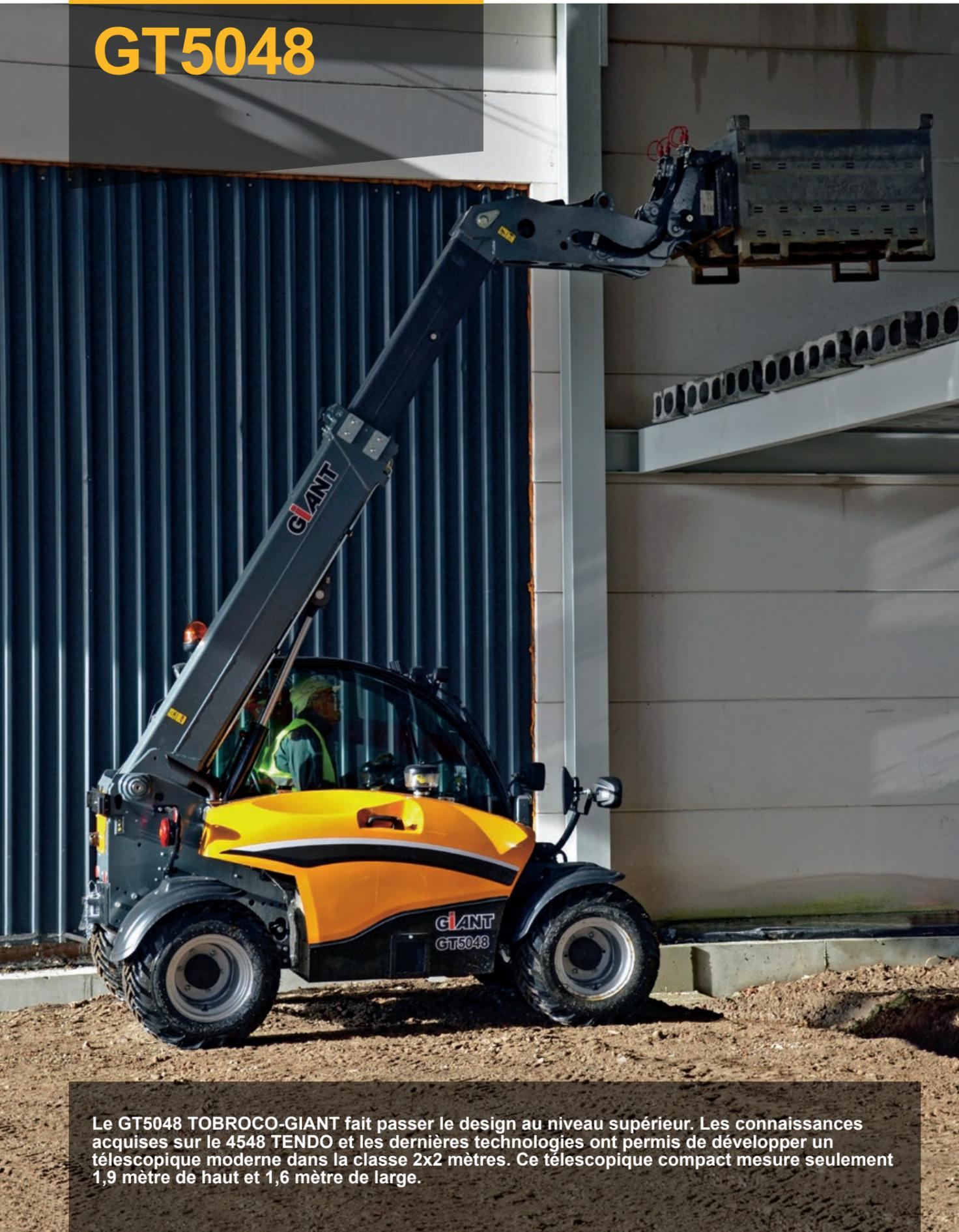
Le GT5048 TOBROCO-GIANT fait passer le design au niveau supérieur. Les connaissances acquises sur le 4548 TENDO et les dernières technologies ont permis de développer un télescopique moderne dans la classe 2x2 mètres. Ce télescopique compact mesure seulement 1,9 mètre de haut et 1,6 mètre de large.
