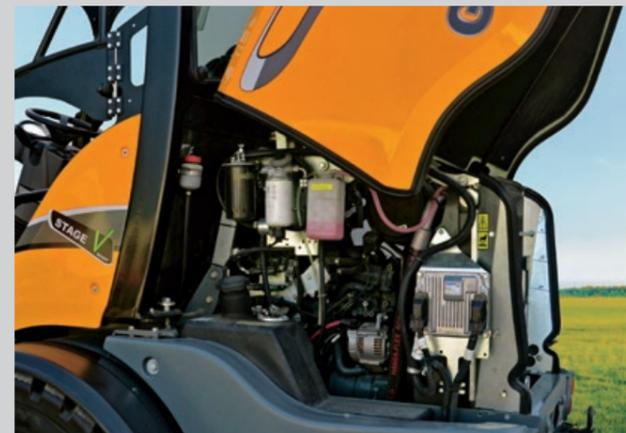
La maintenance du G5000 est très simple grâce à des points de service faciles d'accès. Les filtres, le système hydraulique et le moteur sont libres d'accès sous le capot facile à ouvrir, la cabine inclinable ou d'autres panneaux de service. Les contrôles quotidiens et la maintenance s'effectuent ainsi rapidement et en toute sécurité.
