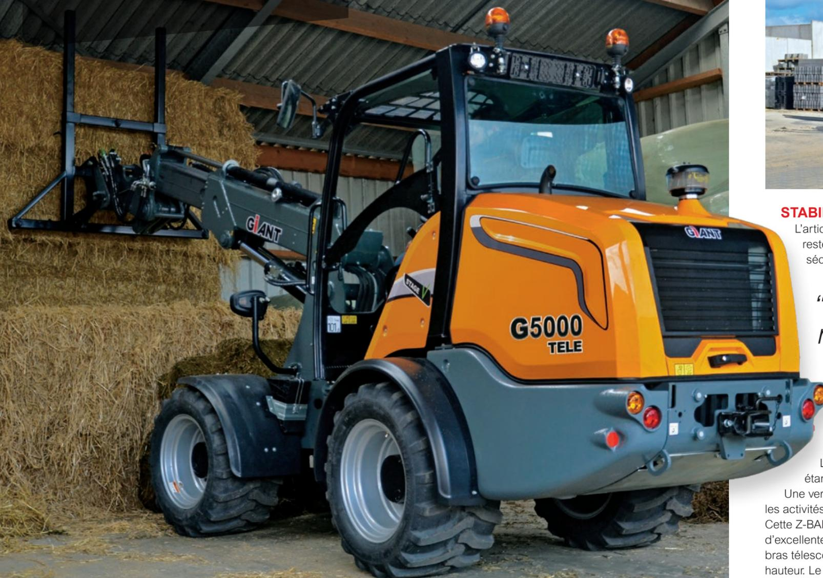
Les modèles G5000 sont conçus pour opérer dans des espaces réduits et sur un terrain accidenté. Cela est rendu possible par le poids réduit et les dimensions compactes : l'articulation pendulaire offre aux machines un petit rayon de braquage et les rend extrêmement maniables. Cela permet de réaliser les travaux de manière extrêmement précise.
