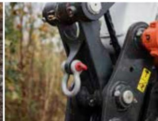
Attache à verrouillage sur axe
