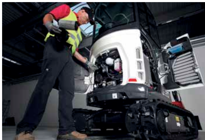
Remplacement des filtres
