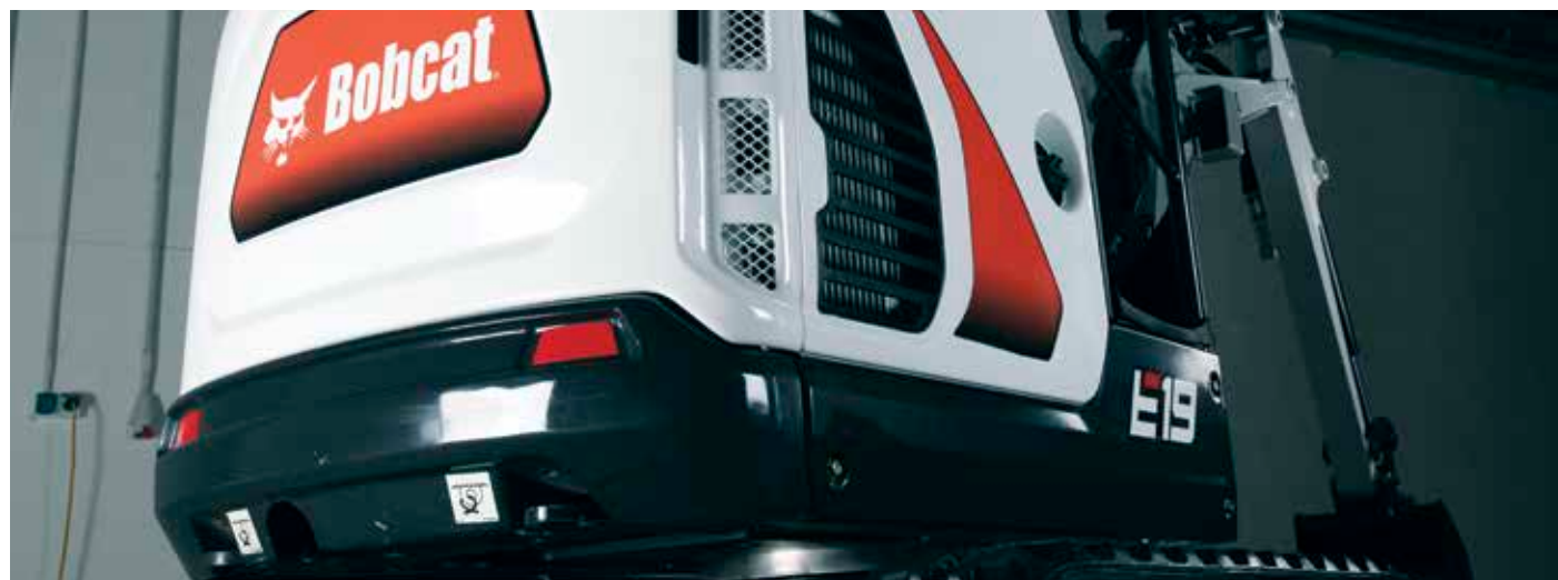
Un contrepoids en fonte protège la porte arrière
