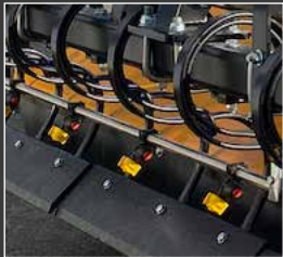
Lame de raclage : 3 sections sur la 2,80 m 2 sections sur les 2,20 et 2,50 m
