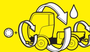
Avec des débits de 0 à 100 l/min et de 0 à 35 l/min, vous disposez d'une voire de deux possibilités d'entraînement supplémentaires en plus de la prise de force mécanique.
